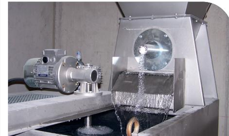
**Pulverdosierung auf Wasserfilm**
