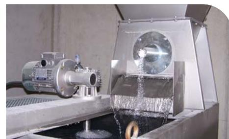
**Dosage de poudre sur film liquide** réglable au moyen d'une tarière de dosage. Commande de tour de vis (en option)
